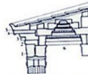
Columna y entablamento: sección (izquierda) y alzado (arriba)
